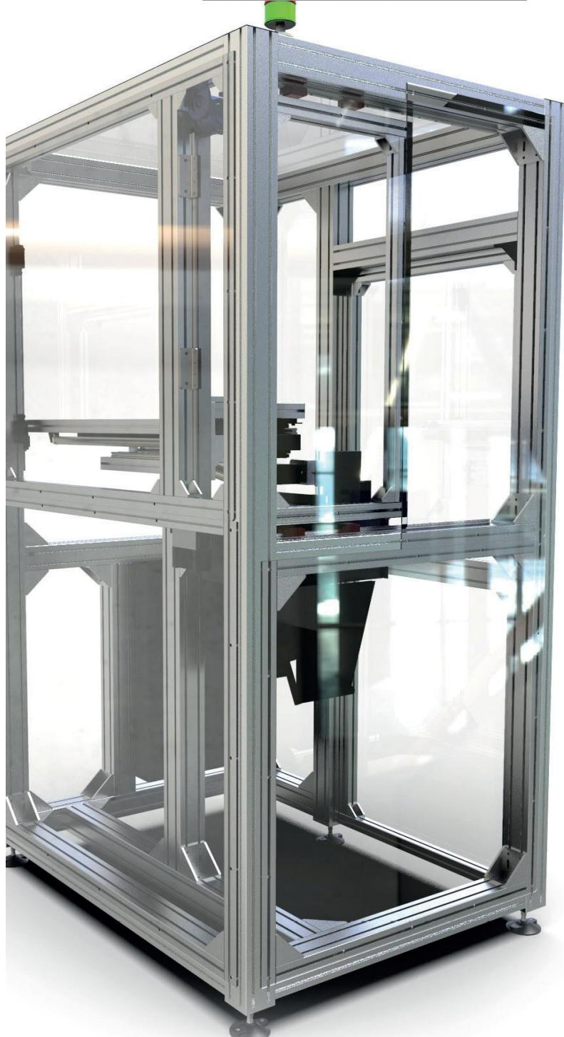
Este modelo se ha diseñado para aplicar, en una sola parada, dos etiquetas; una en el lado del pallet y la otra en la parte superior del pallet. Permite aplicarse de diferentes modos:
