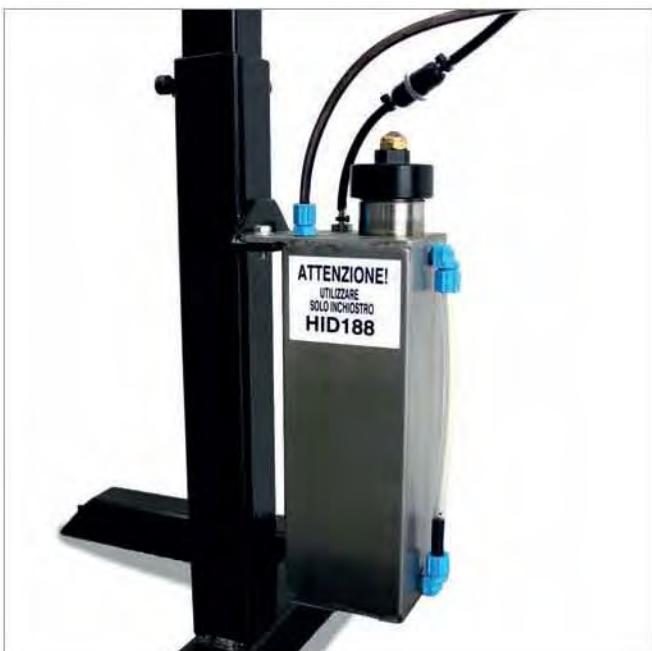
Todos los sistemas de impresión "Hid Touch" incluyen un depósito de tinta de 1,35 litros de capacidad, construido con acero inox, con indicador de nivel de tinta (disponible también de 0,625 y 6,5 litros). Tinta base aceite de diferentes colores.
