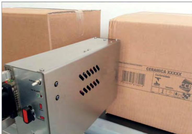
La tecnología ECO A.I.R. incluye un sistema de limpieza y recuperación automática de la tinta aplicada tanto desde arriba hacia abajo y viceversa. Además de garantizar una elevada calidad de impresión, disminuye el consumo de tinta – no se dispersa durante la fase de limpieza – hasta un 30-40%, lo que permite un ahorro significativo en los costes y un menor impacto ambiental.
