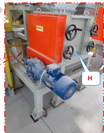
Il prodotto macinato di nuovo dalla seconda cilindraia (H) viene scaricato in modo continuativo nell'elevatore tazze (E), il quale lo scarica di nuovo all'interno del vibrovaglio (F) per un'ulteriore selezione (buono / scarto).
