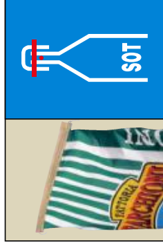
Soldadura interna con aplicación de cubierta de papel crepe (papel + polietileno interno).
