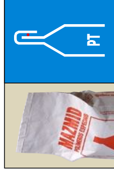
Plegado y encollado (saco pinch top de papel o aluminizado).
