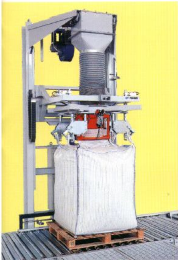
Fase de apoyo del big-bag para su retirada. *
