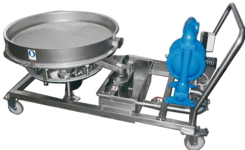
Unidad móvil sobre ruedas para el tamizado, la desferrización y el transporte de esmaltes. El tamaño reducido lo convierte en la máquina ideal para el uso directo en la descarga de los molinos o de las cubas de almacenaje de esmaltes. La versión GRP aplica barras magnéticas de neodimio en un contenedor hermético posterior a la bomba.
