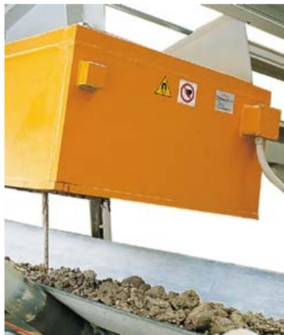
Desferrizador electromagnético de placa, con limpieza automática, para polvos y materias primas en trozos, diseñado para la instalación sobre la cinta de alimentación a los molinos.
