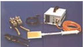
Equipo para el ensamblaje de las correas de transporte System Star, con o sin refuerzo interior.
